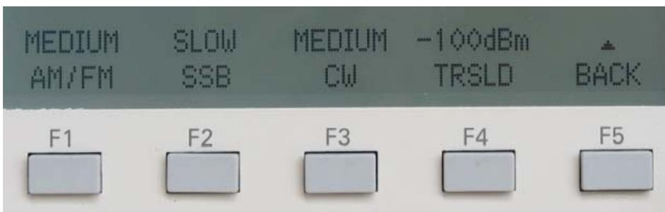
Mit den Funktionstasten F2 und F3 im Menu OPTION werden Attenuator und Vorverstärker eingestellt.
