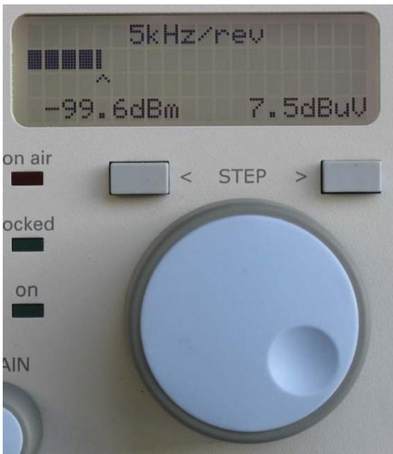
Die Frequenz wird mit dem grossen Drehknopf eingestellt. Die Auflösung des Encoders beträgt 1000 Impulse pro Umdrehung. Die Frequenzänderung pro Umdrehung kann mit den Tasten STEP < und > im Bereich von 500Hz und 100kHz gewählt werden. Der eingestellte Wert wird jeweils im kleinen Display während 5 Sek. angezeigt. Bei sehr schnellem Drehen vergrössert sich die Frequenzänderung progressiv und bei sehr langsamen Drehen wird sie degressiv. Dazwischen liegt ein grosser linearer Bereich.
