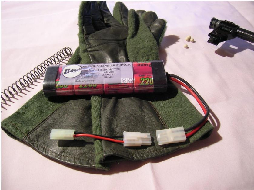
Der Medium Type ist der **Allrounder unter den Airsoft-Akkupacks**. Er verfügt über eine ausreichende Kapazität (1600-2400mAh) um auch längere Spiele zu bestehen. Gut kombiniert mit den 4/5 Sub-C Zellen ist er sehr leistungsfähig und passt in mittleren und langen Waffen oft ohne weitere Modifikation.
