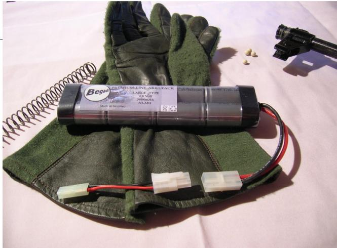
Ein Large-Type bietet das **absolute Maximum an Leistung**, sofern er hochwertige Zellen verwendet. Standardmäßig basiert ein Large-Type Akku auf den sehr großen Sub-C Zellen. So werden Kapazitäten bis 4000mAh ohne Weiteres möglich. Größter Vorteil dieses Akkupacks ist damit die lange Spielzeit, die man mit ihm erreicht. Auch 3-Tagesspiele können so ohne neue Aufladung bestritten werden. Außerdem lassen sich besonders Gearbox-Jam anfällige Waffen mit den hohen mAh-Werten gut betreiben.
