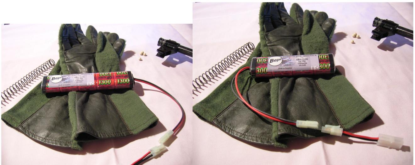
Dieser Akkupack ist für **Air-Soft-Guns mit geringen Platzverhältnissen** gedacht. Er verfügt über eine geringe Kapazität (zwischen 600 und 1400mAh Real-Leistung) und verwendet hauptsächlich die kleinen 2/3 A –Zellen. So bleibt seine geringe Größe auch bei 9,6 Volt (8 x 1,2V) gewahrt.
