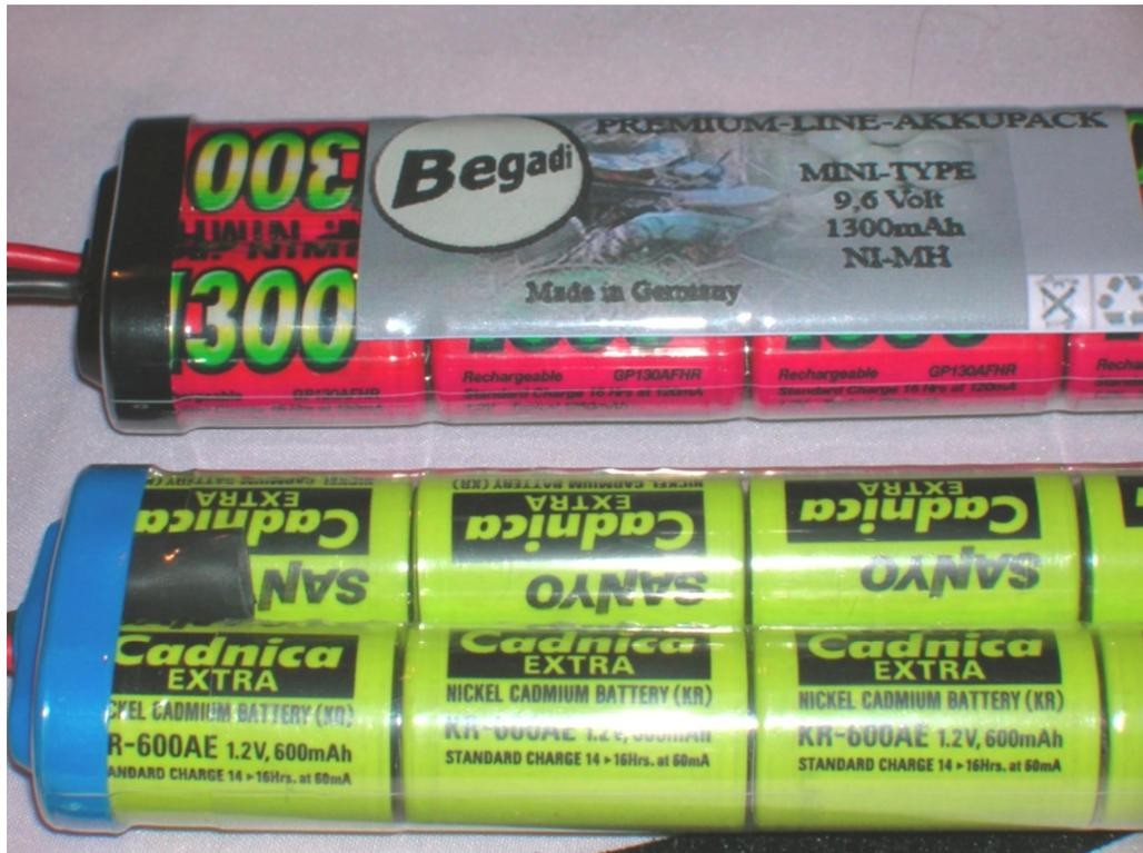
Im Airsoftbereich werden hauptsächlich 2 Typen von Zellen benutzt. Zum einen die modernen NickelMetallHydrid- (**NiMH**) und zum anderen die günstigen, aber technisch veralteten NickelCadmium (**NiCD**)-Akkus.
