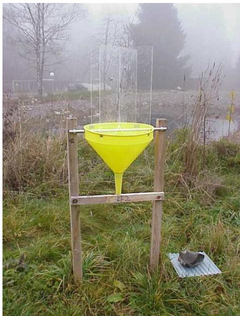
*Die Flugfalle (Bildmitte) und die bedeckte Bodenfalle (rechts unten). Die Flugfalle ist ca. 1.5m hoch. Die Bodenfalle besteht aus drei Yoghurtbechern, die im Boden eingegraben sind und mit einem Regenschutz geschützt sind.*
