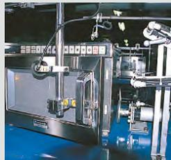
**Dauerprüfung der Tür (Öffnen und Schließen)\*4**
