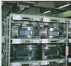
**Dauerprüfung bei intermittierendem Betrieb\*4**
