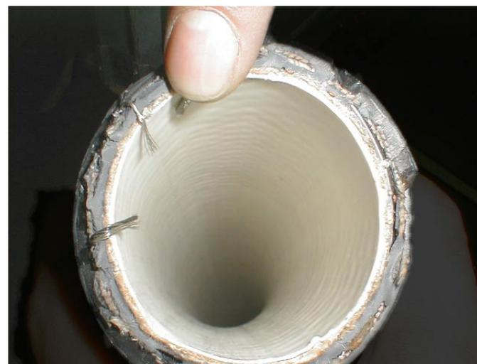
Kupferlitzen so kürzen, dass sie ca. 10 mm in den Schlauch hineinragen. Litzen längs zur Schlauchrichtung nach innen biegen.
